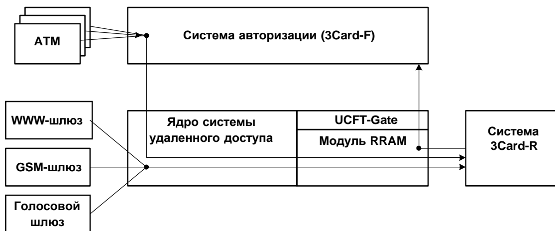
Рисунок 6 Схема взаимодействия модуля RRAM
